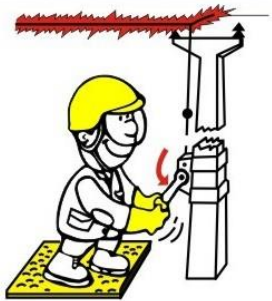
Cortar las fuentes de tensión
