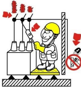
Verificar ausencia de tensión
