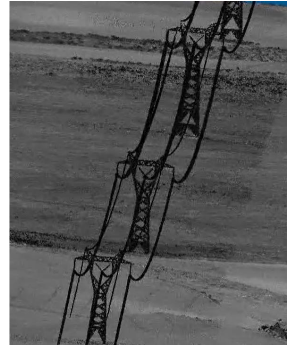
LiDAR: Entre 100 – 300 puntos por m2
